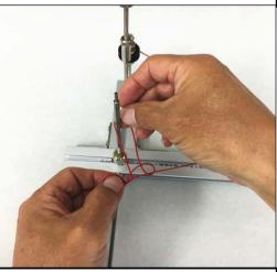
17 さらにラインを引き出してノズルへ運びます。 18 漁師結びのハリスを通す部分をノズルに掛けます。 (ここまでの作業を編み棒を使って行うことも出来ます。)
