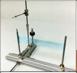
5 最後に「エダス間隔」を調整します。後の 工程で写真のようにUターンロッドをラインが 往復します。
