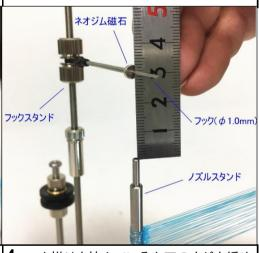
3次に「ハリス長さ」を調整します。写真のよ ┃4フック掛けを挟んでいる上下のネジを緩め て高さを調整します。
