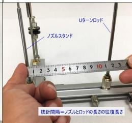
6 Uターンロッドの下部ツマミにててエダス間 隔の約半分に調整します。ツマミは強く締め てください。
