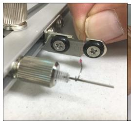
1 枝針部品のハリスを一定の長さにカットす 2 ハリスカッターのフック側掛けのツマミをる治具の調整です。(オプション品) 緩めて移動するとカッター刃との間隔が調整 ※刃は市販カッター刃を使用しています
