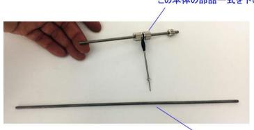
この本体の部品一式を下の全ネジに移植して使います。
