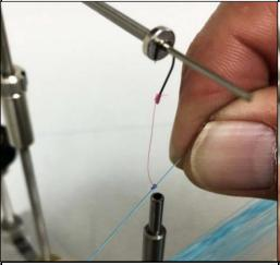
5 ノズルの頂部で、クキッという感触まで締 め込みます。結び目に事前にスポイドで水をカッターで予め長さを合わせていればこの作 付けて摩擦熱を防ぐ人もいます。
