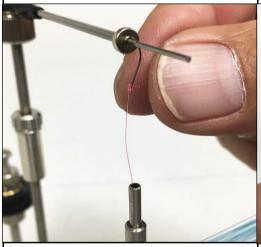
3 針をフック掛けに掛けます。ネオジム磁石 を付けていますのでピタッと付きます。
